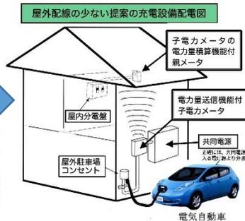
各世帯の電力積算計を親メータとして各利用者個人用の駐車場の充電用子メータを管理するため、従来の集合住宅での充電設備設置上の問題点（費用分担、利用者範囲の規定、集金管理、共同利用時の利便性の悪化等）が解決でき、さらに各世帯の最大電力使用量が親メータの制限内であるため建物全体での最大電力総使用量に影響せず、電力の平準化は不要となり、キュービクルの交換や電気の基本料金の上昇等は発生しないためマンション組合での承認を得やすくなる。
